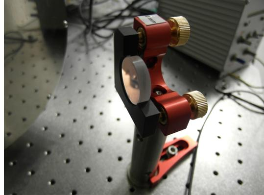
Abbildung 3.1(a) Faserkoppler des Spektrometers
