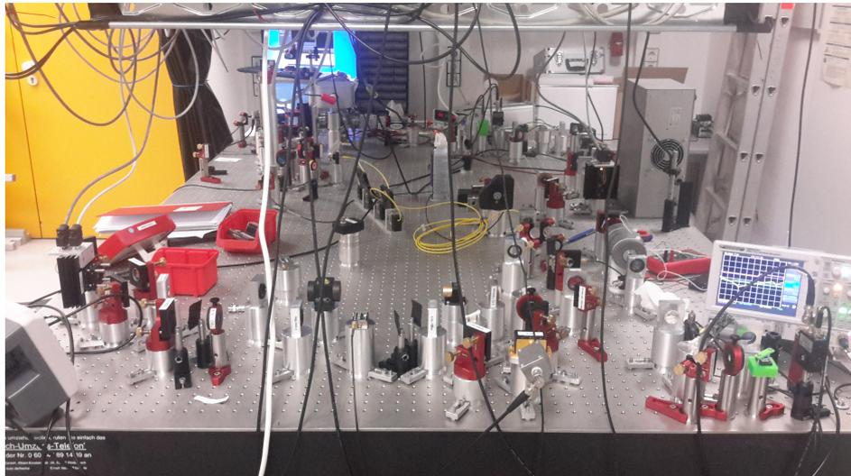
Abbildung A.8.: Aufnahme des neuen Aufbaus für den Rückpump-Laser. Anzumerken hier ist, dass in diesem Aufbau auch zwei AOMs zur Rotverschiebung vorhanden sind, diese allerdings nur zu Testzwecken in dem Aufbau eingebaut wurden sind und für die Erzeugung der MOT nicht eingeschaltet waren.
