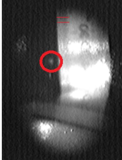
Abbildung A.11.: Aufnahme der MOT (im roten Kreis) von  $^{85}\text{Rb}$  mit Skala. Da die Skala auf dem Bild nicht gut zu erkennen ist, wurde nachträglich die Skala eingezeichnet, wobei der Abstand zwischen den zwei roten Linen 2 mm entspricht. Im Labor war die Ausdehnung der MOT deutlicher ablesbar.
