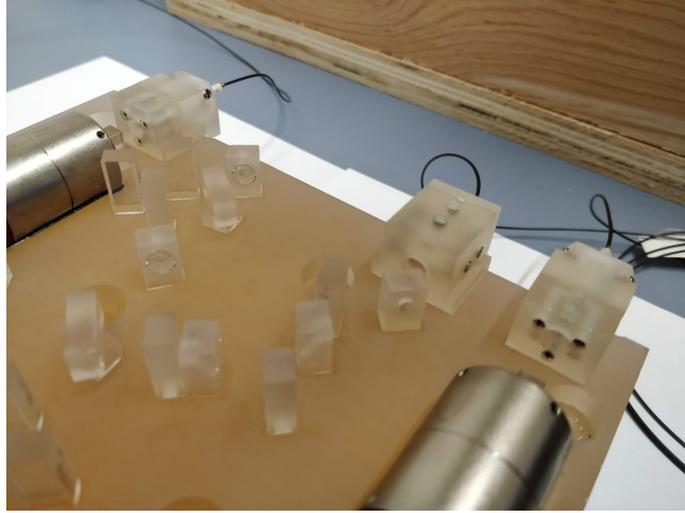
Abbildung 1.1.: ZERODUR-Modul mit drei Faserkopplern im Hintergrund
