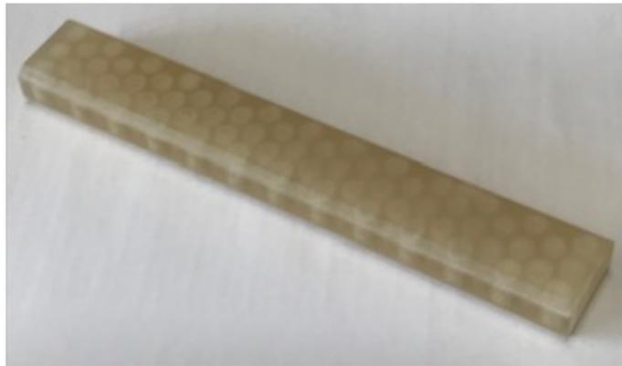
Abbildung 5.6.: ZERODUR-Platte mit innerem Lochraster in Bienenwabenanordnung. Im mittleren Teil der Platte befindet sich das Lochraster, welches durch eine oben und eine unten aufgeklebte Deckplatte versiegelt ist.
